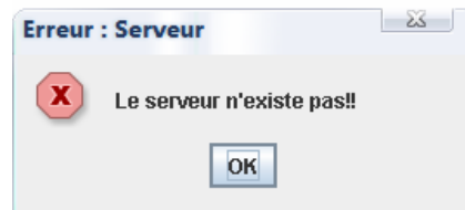
Fig.13.2 Mauvais nom de serveur.
